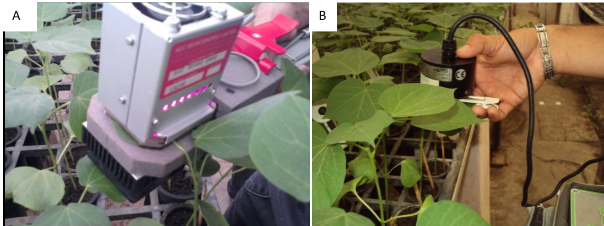
Figura 4. Utilização do IRGA para obtenção das taxas fotossintéticas (A) e da fluorescência (B), nos genótipos de algodão colorido, em função dos tratamentos. Campina Grande, 2012.
